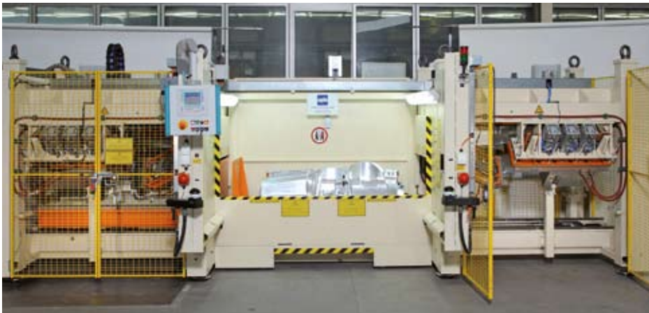
Presskaschieranlage für Leder Instrumententafel LL/RL
