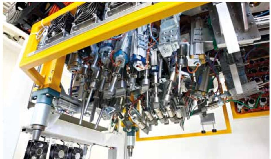
Komplexes Ultraschall Füge-Werkzeug mit Ultraschall-Standardkomponenten
