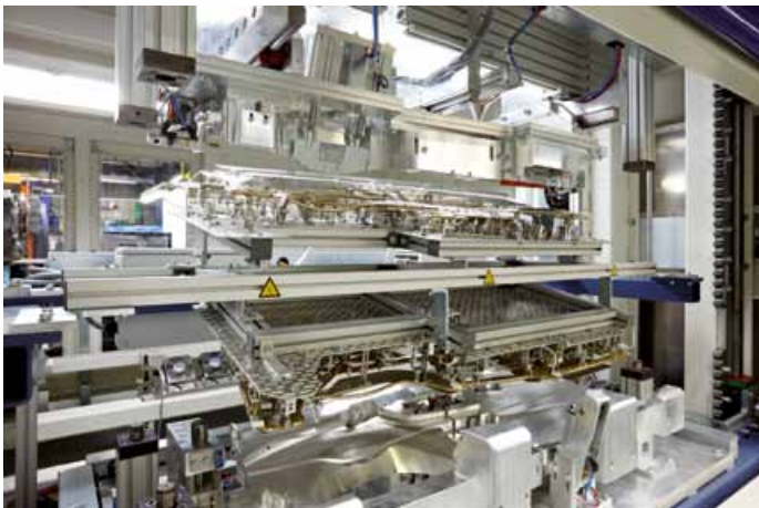
Komplexes Infrarot Instrumententafel-Werkzeug mit Standardstrahlern, Konturstrahlern und Schattenblechen
