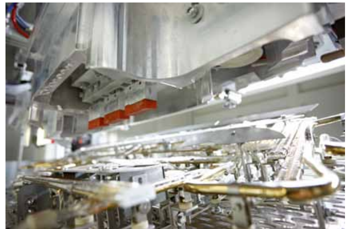
Artikelaufnahme mit autark angetriebenem 3D Niederhaltersystem
