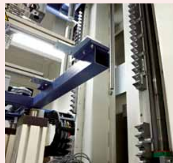
Hubwerk mit Roller Pinion System (RPS), Führung über Servoantrieben mit Absolutwertgeber
